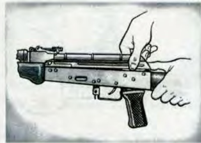
Рис. 20. Отделение крышки ствольной коробки
