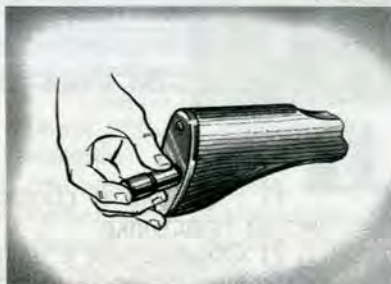
Рис. 25. Вкладывание пенала в гнездо приклада
