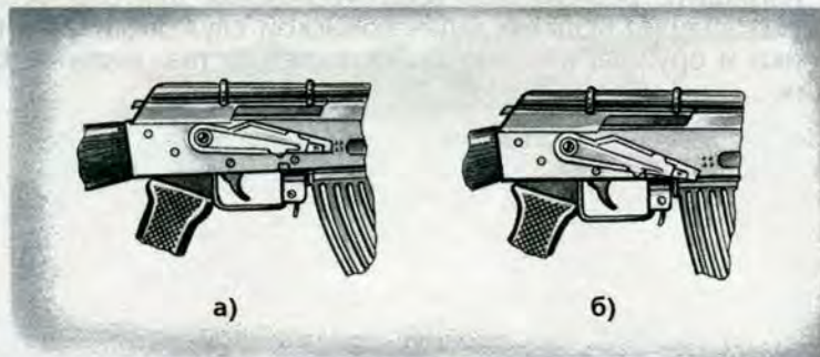
Рис. 32. Установка переводчика на необходимый вид огня: а — для ведения автоматического огня; б — для ведения одиночного огня
