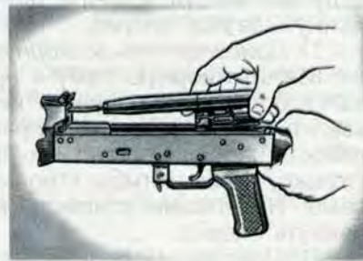
Рис. 22. Отделение затворной рамы с затвором
